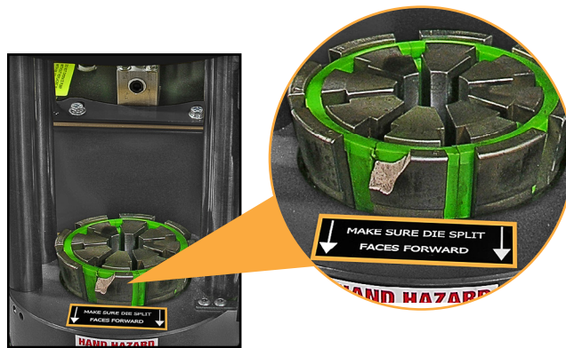
Broken Die Finger
